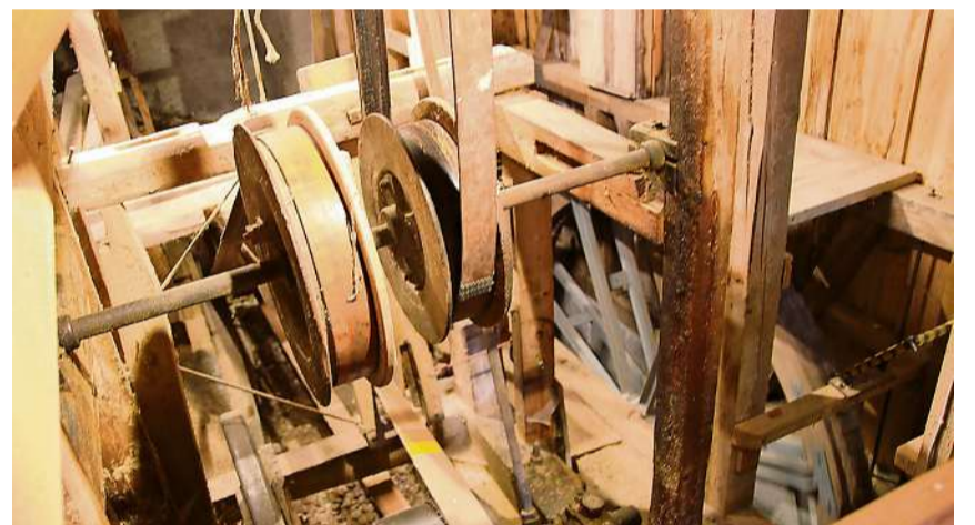
Der Sägeantrieb mit dem gespeichten und gezahnten Kammrad.
