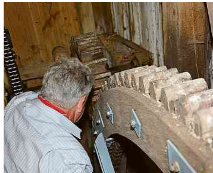
Fritz Rutz verbindet das Kammrad (rechts) mit dem Zahnrad.
