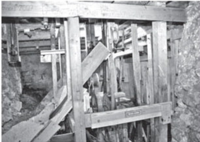
Die Räder, die das Gatter antreiben, werden ihrerseits vom Kammrad angetrieben.
