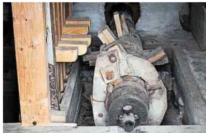
Der Wellenbaum treibt die Stampfen (links) an.
