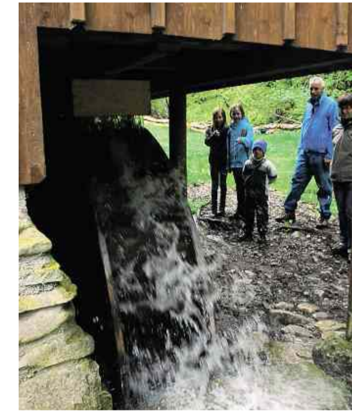
Ein Wasserrad bringt den Wellenbaum der «Beistampfi» in Schwung. Lukas Heim (blaue Jacke) erklärt den Besuchern die Mühle.
