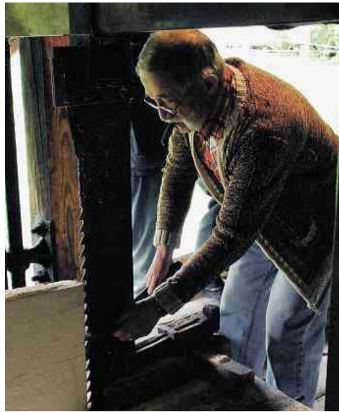
Leo Rütthemann stellt an der Säge Hätschberg die Dicke der Bretter ein, die aus dem Trämel gesägt werden.
